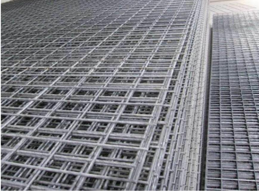
当需要代换时，须征得设计单位同意，必须符合下列规定。不同种类钢筋的代换，须按钢筋受拉承载力设计值相等的原则进行；当构件受抗裂、裂缝宽度或挠度控制时，钢筋代换后须进行抗裂、裂缝宽度或挠度验算；钢筋代换后，须满足混凝土结构设计规范中所规定的钢筋间距、锚固长度、较小钢筋直径、根数等要求；对重要构件，不得用HPB235光面钢筋代换变形（带肋）钢筋；梁的纵向受力钢筋与弯起钢筋须分别进行代换；对有抗震要求的框架，不得以强度等级较高的钢筋代替原设计中的钢筋；预制构件的吊环，必须采用未经冷拉的HPB235热轧钢筋制作，严禁以其他钢筋代换。钢筋加工，就选上海澳坤建材有限公司，用户的信赖之选，有需要可以联系我司哦！
